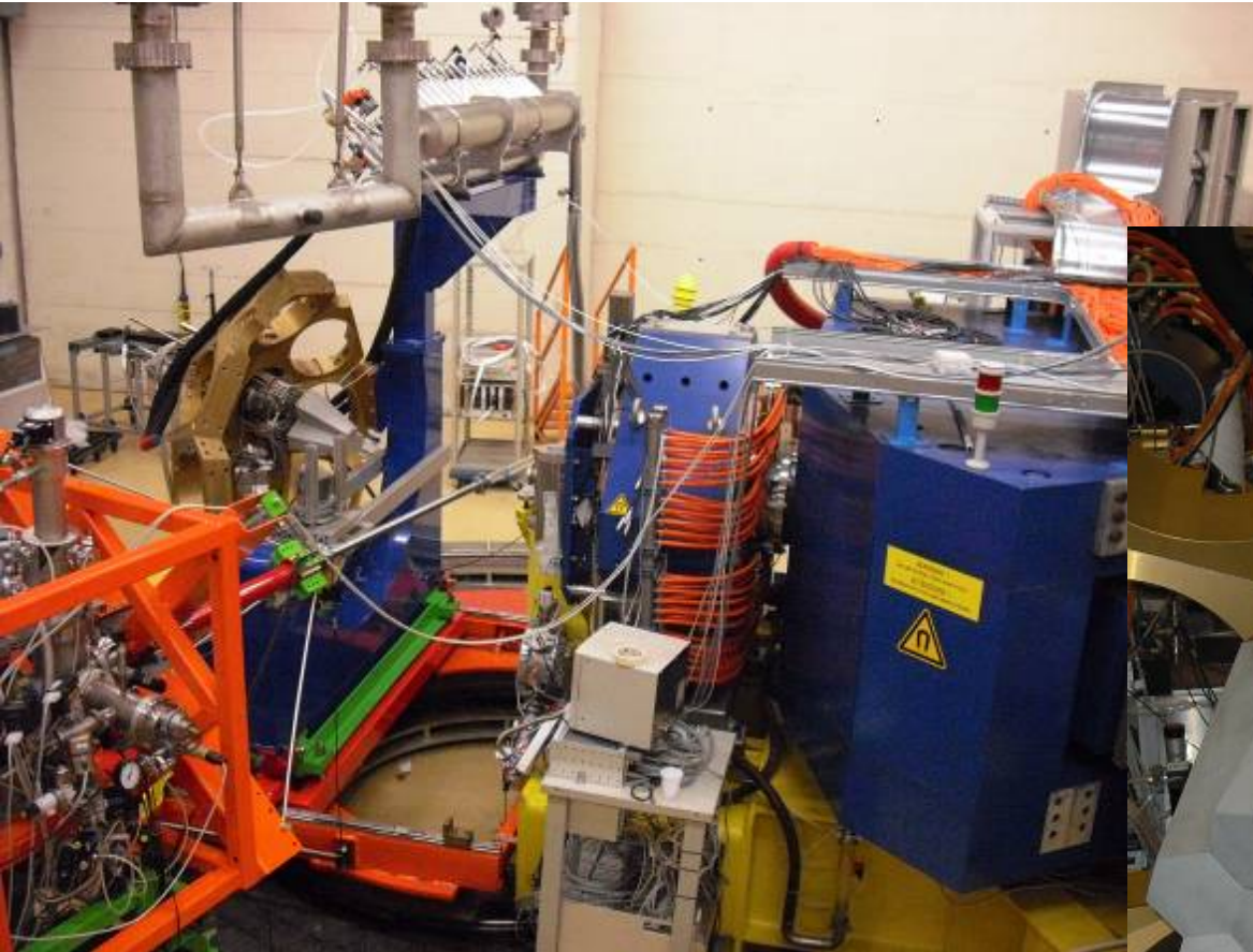
3 ATCs an Targetposition des PRISMA-Spektrometers am LNL
