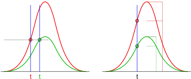
Abbildung 2: Einfacher Schwellendiskriminator (links) und Constant-Fraction-Discriminator (CFD) (rechts). Die beiden Signale haben den gleichen Startzeitpunkt, überschreiten den Schwellenwert aber zu unterschiedlichen Zeitpunkten. Dieser Walk genannte Effekt wird beim CFD vermieden. Bild: [11]
